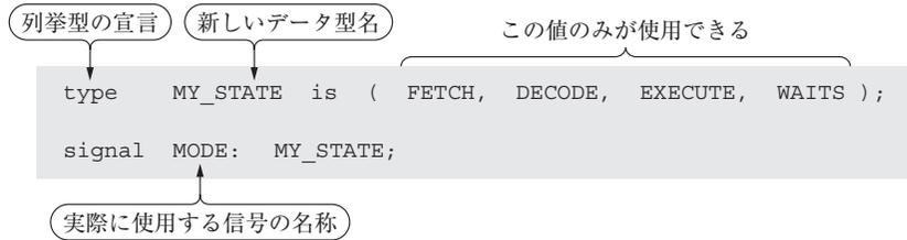
図 23-7 自動演奏プロセッサでの列挙型の使用例
